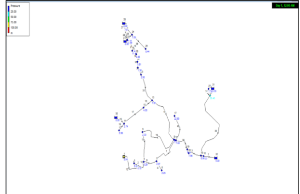
Gambar 2. Distribusi Tekanan Hasil Simulasi EPANET 2.2
