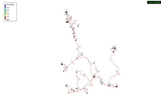
Gambar 3. Distribusi Unit Headloss Hasil Simulasi EPANET 2.2
